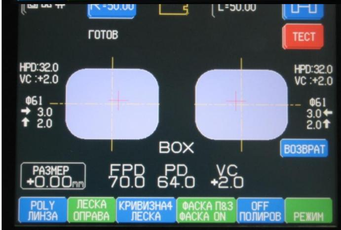
Включите функцию полировки линзы нажав кнопку OFF ПОЛИРОВ.
