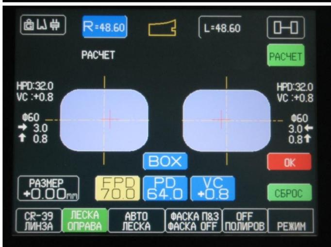
Введите параметр межцентрового расстояния оправы, если сканирование производилось по одному проему оправы, правому или левому.
